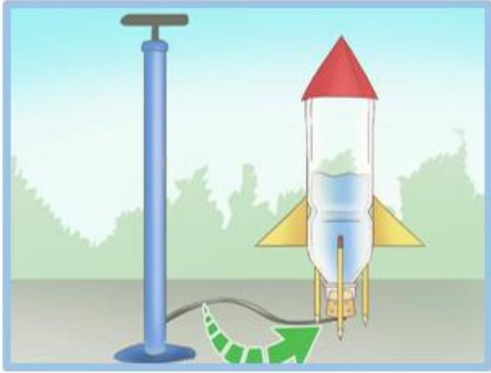
Pwmpiwch aer mewn i'r potel. Defnyddiwch pwmp beic. Rhowch nodwydd y pwmp mewn trwy'r corcyn, yna pwmpiwch.
